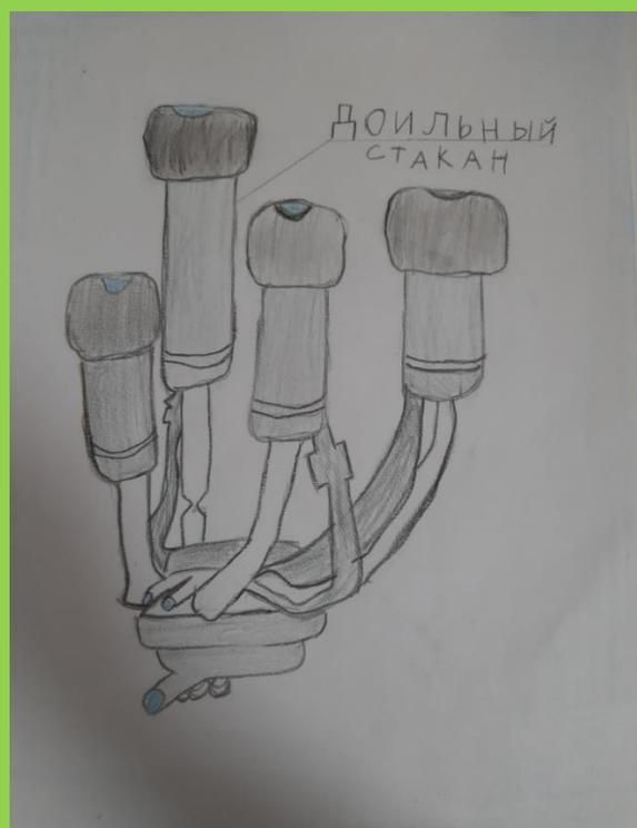
Стаканы состоят из корпуса, изготовленного из нержавеющей стали, сосковой резины внешней и внутренней. Молочные шланги предназначены для подачи молока. Вакуумные шланги предназначены для откачки воздуха.
